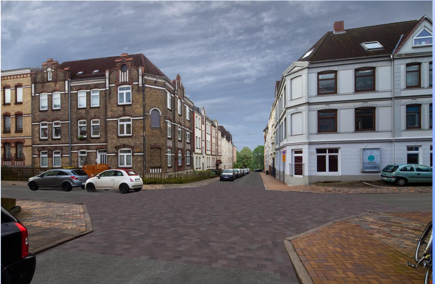
4.3a Mischvariante Asphalt/ Großstein Granit gesägt und in Pflastermörtel verlegt
