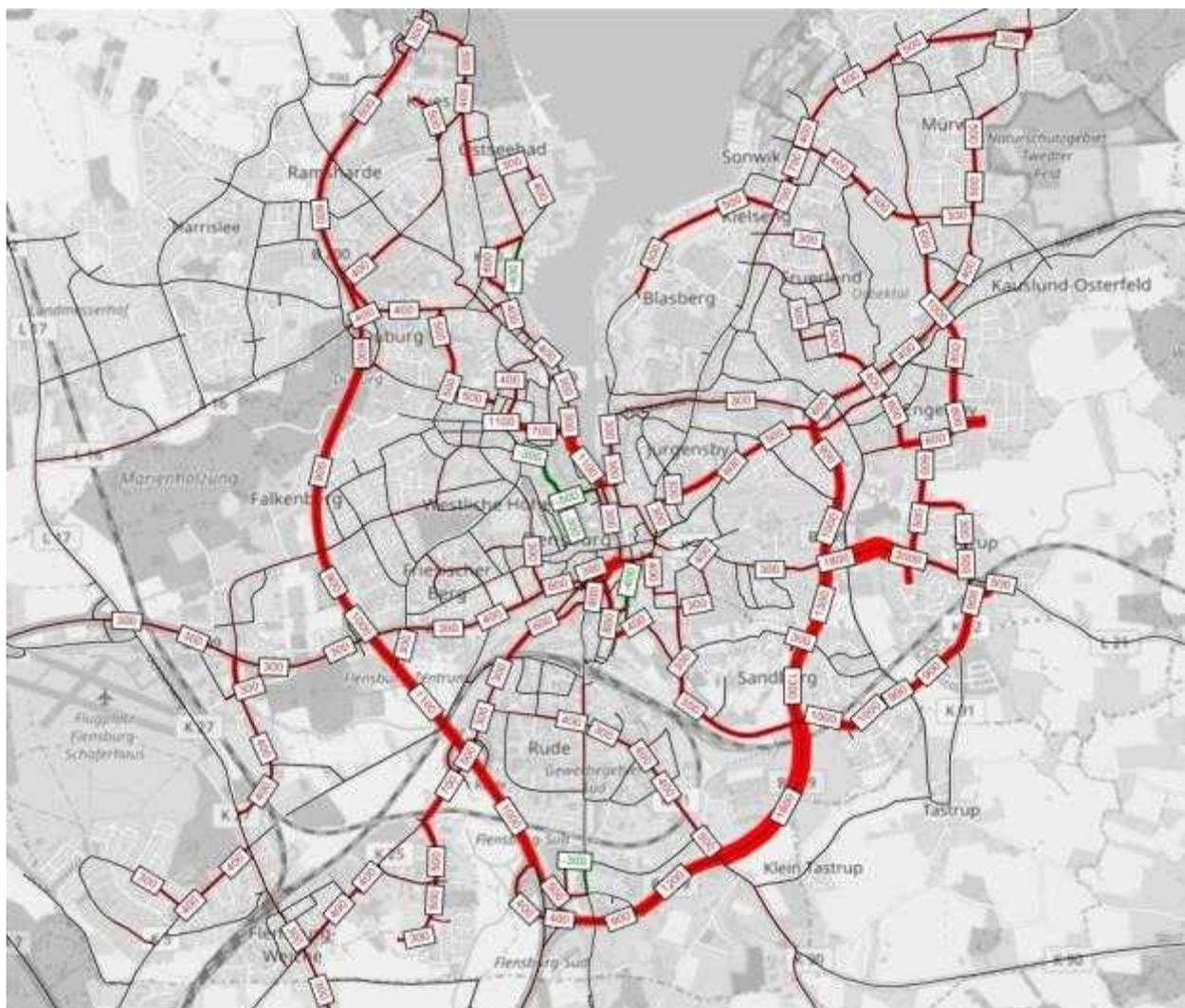
Abb. 70 Differenz der täglichen Verkehrsbelastung zwischen Analyse-Nullfall und Prognose-Nullfall-Szenario
