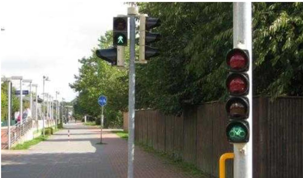
Abb. 36 Getrennte Signalisierung des Radverkehrs und des Fußgängerverkehrs (Hannover)
